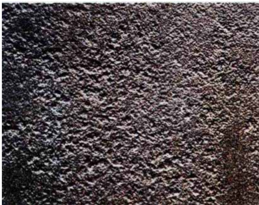
شکل ۲۸- تصویر درجه تمیزکاری با شعله DFL
