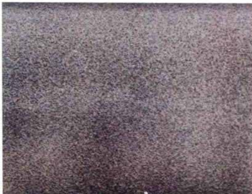
شکل ۱۲- تصویر درجه تمیزکاری پاششی کامل CSa2
