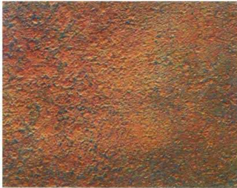
شکل ۲۳- تصویر درجه تمیزکاری دستی و ماشینی کامل DSt2
