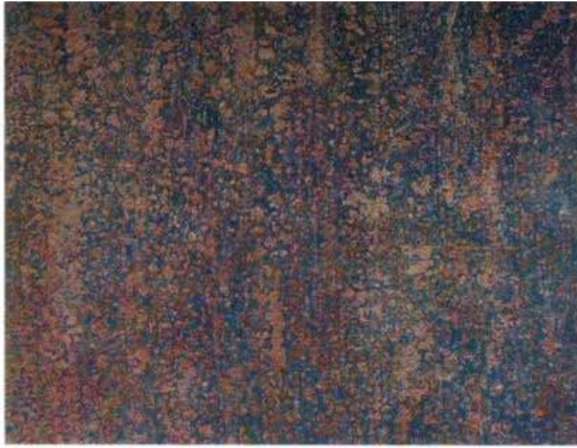
شکل ۷- تصویر درجه تمیزکاری پاششی سبک B Sa1
