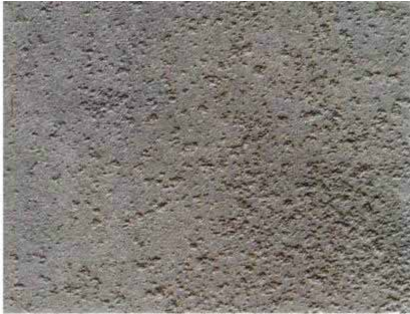
شکل ۱۷- تصویر درجه تمیزکاری پاششی خیلی کامل DSa2 \frac{1}{2}
