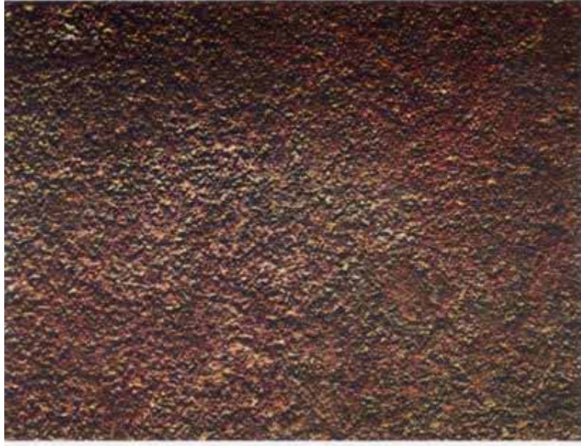
شکل ۳- تصویر زنگ زدگی درجه C
