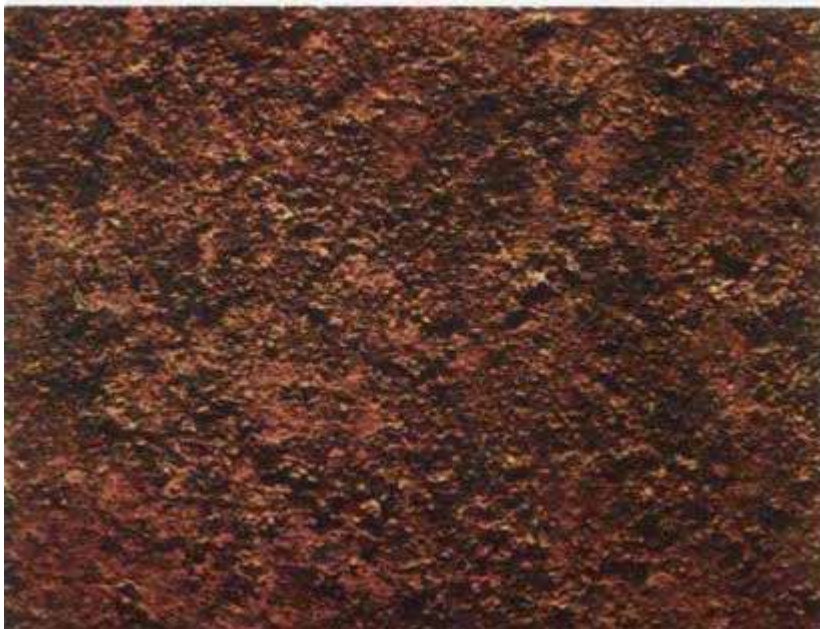
شکل ۴- تصویر زنگ زدگی درجه D
