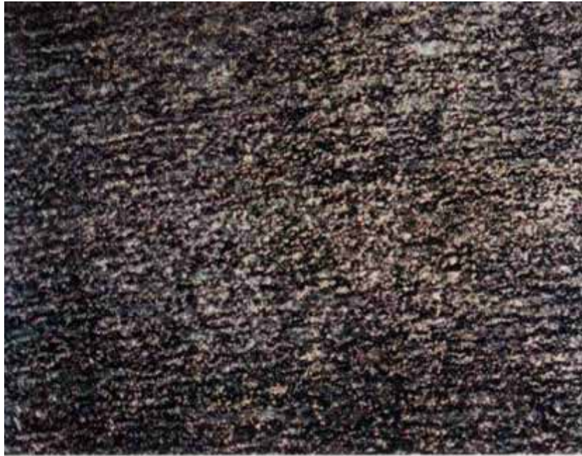
شکل ۲۷- تصویر درجه تمیزکاری با شعله CFL
