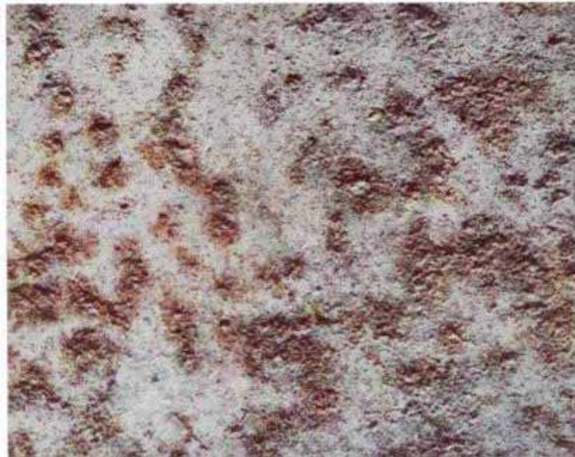
شکل ۱۶- تصویر درجه تمیزکاری پاششی کامل DSa2
