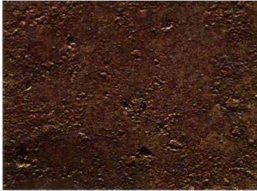
شکل ۱۵- تصویر درجه تمیزکاری پاششی سبک DSa1
