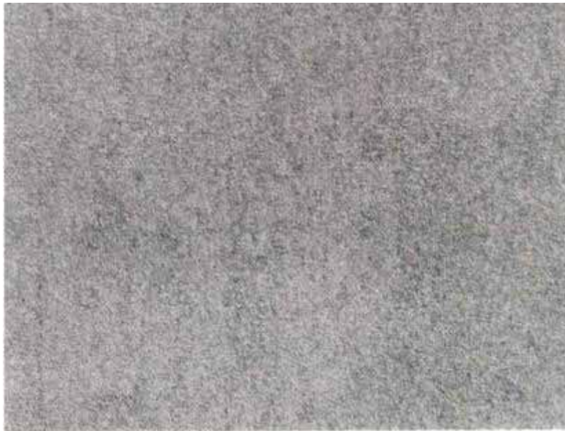
شکل ۹- تصویر درجه تمیزکاری پاششی خیلی کامل BSa2 \frac{1}{2}
