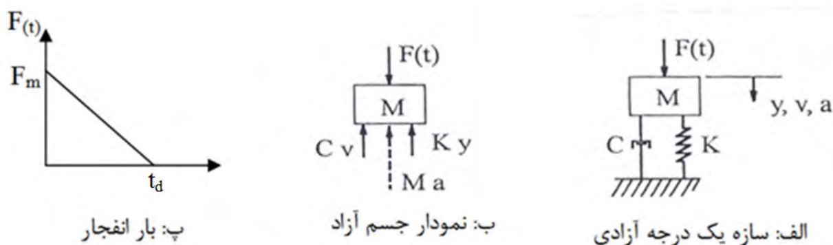
شکل ۳-۶-۲۱- مدل سازه یک درجه آزادی برای تحلیل دینامیکی
