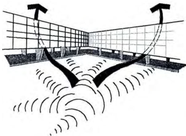
شکل ۲۱-۲-۹- تخلیه سریع نیروهای انفجار از فضای پیلوت باز
